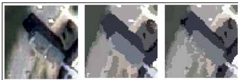
Figure 5 : Comparaison entre une segmentation par coopération régions-contours (au centre) et celle par croissance de régions (image droite). Image originale (image gauche). Comparison between the result of a region-edge cooperative segmentation (at the center) and the one by region growing segmentation (on the right). Original image (on the left).
